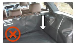
NO SLOT IN BOOT-LINER, COVERING THE D-RING
